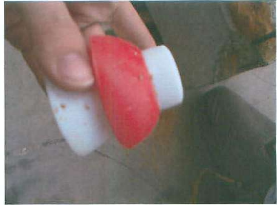
Fotografía 17: Estado de la protección que quedó introducida en el interior del saco. Desplazamiento relativo pieza blanca y roja.
