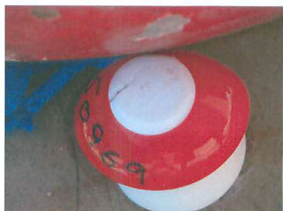
Fotografía 11: Detalle de las protecciones tras el impacto.
