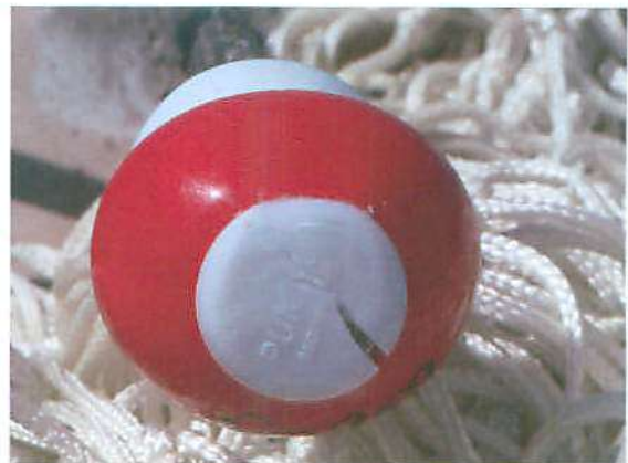
Fotografía 9: Detalle de las fisuras parciales apreciadas en una de las protecciones
