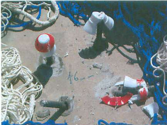
Fotografía 12: Perforación de las protecciones tras el impacto.
