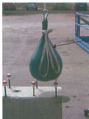
Fotografía 3: Disposición ensayo mediante choque por cuerpo blando
