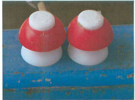
Fotografía 19: Estado de las dos protecciones que quedaron en el interior del saco tras el impacto.
