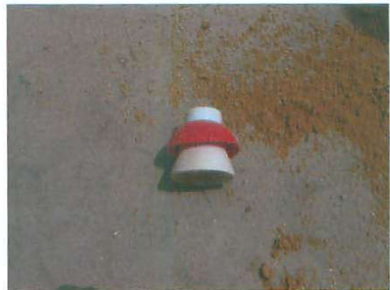
Fotografía 23: Detalle del estado de una de las protecciones que quedó en el interior del saco. No hay perforación de la armadura de acero a través de la pieza plástica.
