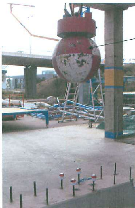
Fotografía 2: Disposición Ensayo Cuerpo Rígido
