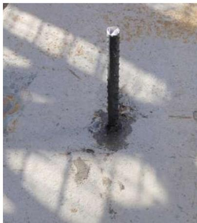
**Fotografía 3: Disposición de la barra sobre la estructura soporte de ensayo.**
