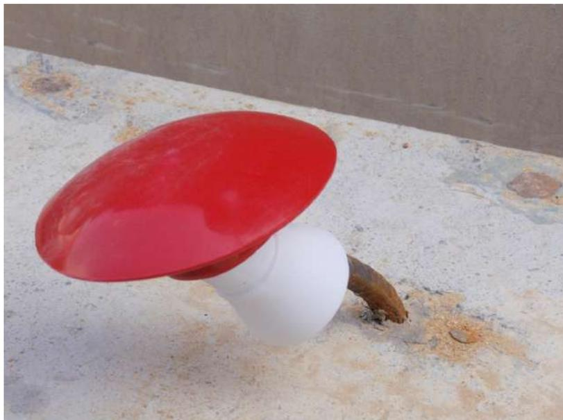
**Fotografía 7: Disposición de la protección tras el primer impacto. No se produce perforación de la barra en la protección.**
